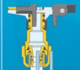
La parte roscada se conecta directamente al racor que se une al tubo del circuito. Este sistema de conexión permite montar el racor-adaptador en el tubo fuera de la caja y luego fijarlo al cuerpo del colector, lo que facilita la instalación hidráulica.
